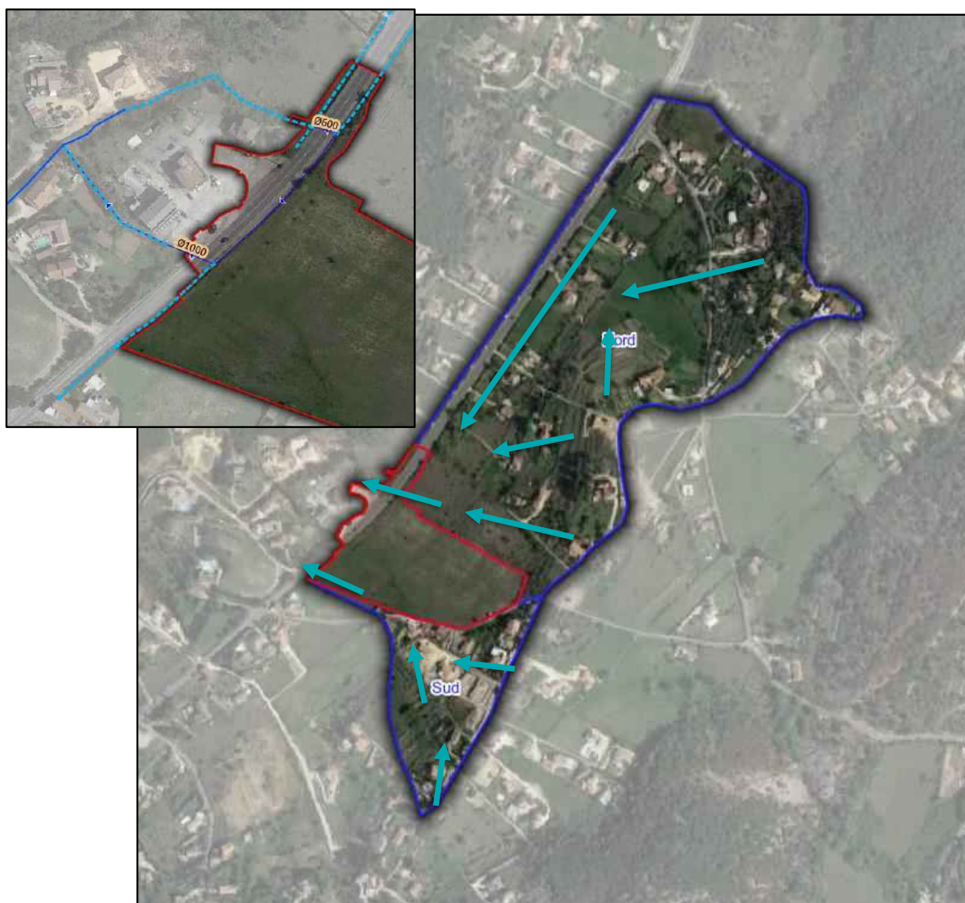
Figure 11 : Fonctionnement hydraulique actuel (Source : Etude hydraulique Cereg, 2023)
