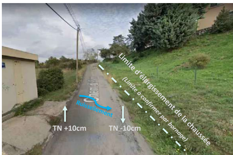
Photo 3 : Illustration du principe de reprofilage
