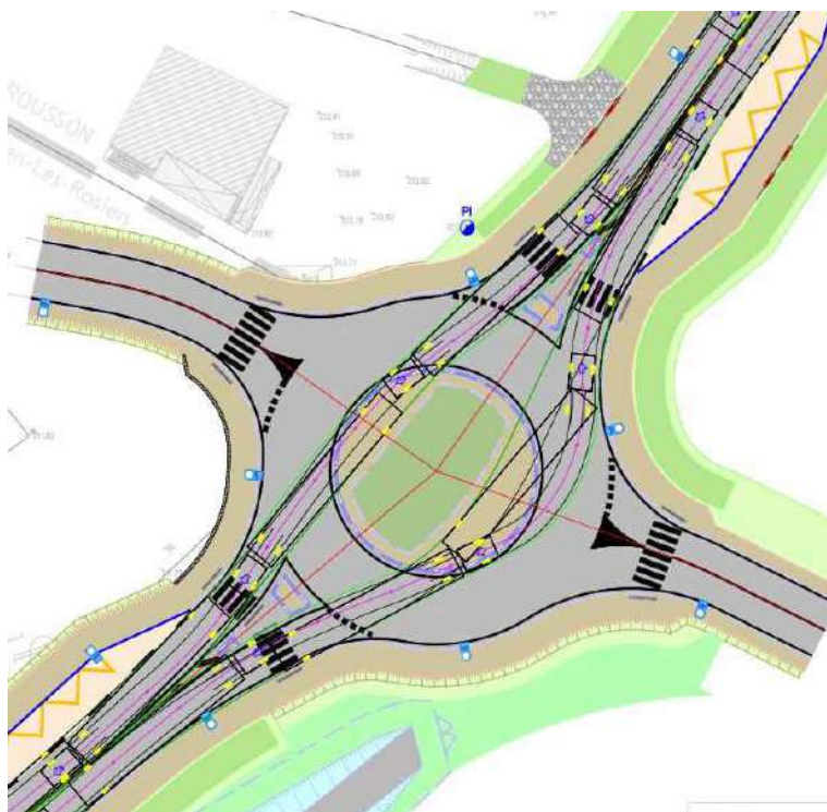
Plan 6 : Epure de giration d'un PL à 15kmh/h
