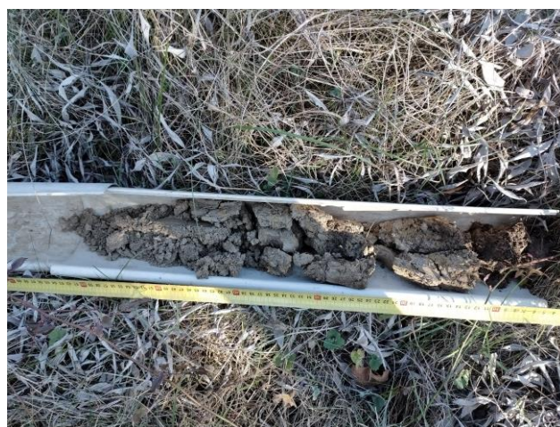
Illustration 19 : Sondage n°6 – Sondage dans zone de débordement du cours d'eau, traces d'hydromorphies
