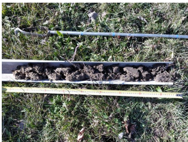
Illustration 18 : Sondage n°1 – Sondage sur la zone de projet, pas de trace d'hydromorphie
