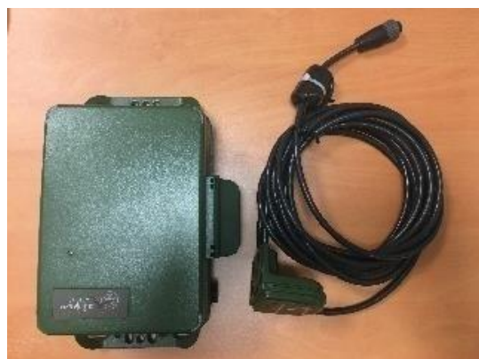
Figure 15 : Enregistreur SM4Bat avec microphone U2
