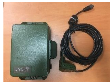
Figure 32 : Enregistreur SM4Bat avec microphone U2
