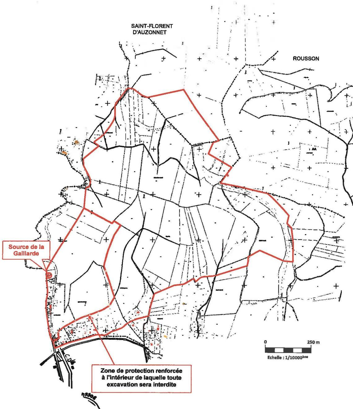
Figure 9 - Périmètre de Protection Rapprochée du captage de la source de la Gaillarde (sur plan cadastral)
